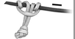
Fixieren des Knotens: Ende Anschlagtampen festhalten und die Bucht "nach hinten weg-streifen". Die Waagenleine wird im Knoten unverrutschbar eingeklemmt.
